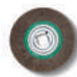
Spazzola in acciaio Ø 250 mm x 60 mm, con un'elevata capacità di asportazione per un impiego estremamente redditizio, foro di attacco Ø 51 mm. Fili metallici con uno spessore di 0,2 mm per tubi e profilati dalle pareti sottili. Fili metallici con uno spessore di 0,35 mm per l'impiego universale. Fili metallici con uno spessore di 0,5 mm per tubi e profilati a parete spessa e per una potenza di sbavatura elevata.
