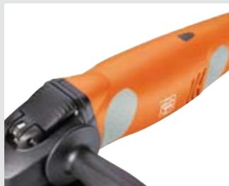
Il sistema di comando «senza interruttori» FEIN TipStart con funzione AutoStop assicura la massima sicurezza d'uso. Grazie al sistema di frenatura elettronico EBS, al rilascio dei pulsanti il disco si ferma in soli 3 secondi.
