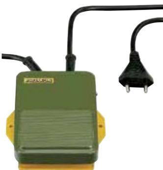
Per tutti gli utensili con spina Euro 220 V. (protezione classe 2) e un'assorbimento fino a 500 W. Adatto anche per utensili stazionari. Cassa in NYLON rinforzato in fibra di vetro. Cavo di allacciamento alla rete 230 V. da 2,5 metri. Cavo in uscita lungo 50 cm. Nell'uso con utensili a 12 Volt l'interruttore comanda il trasformatore.
