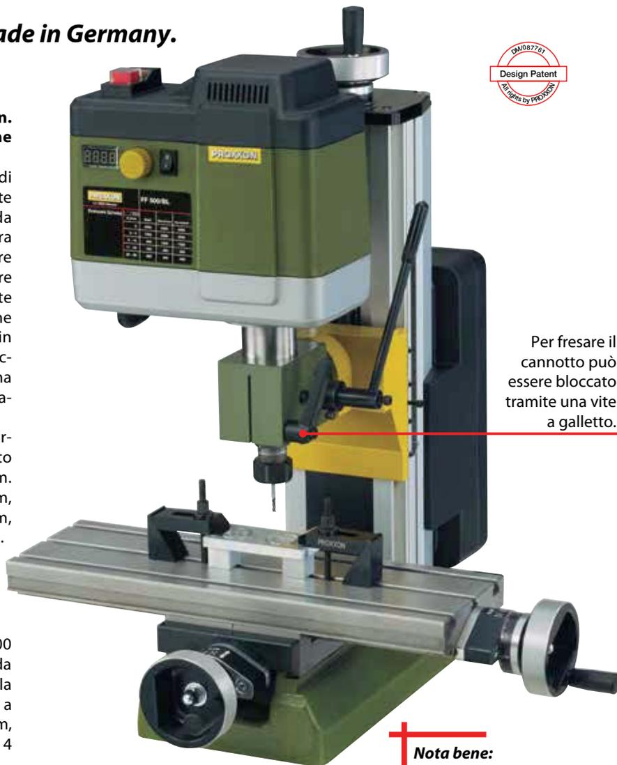
Per fresare il cannotto può essere bloccato tramite una vite a galletto.
