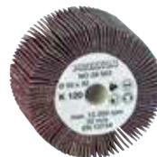
Per pulire, smerigliare e asportare superfici piane. Le lamelle abrasive in corindone normale sono elastiche e seguono i bordi del pezzo da lavorare. Ø 50 mm, larghezza 30 mm.
