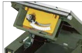
Per la pulizia della macchina e per la sostituzione della lama il tavolo con il gruppo motore possono essere aperti e bloccati come il cofano di un'automobile.
