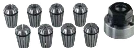
Per la lavorazione molto precisa di pezzi tondi. La attrezzatura con pinze va montata al posto del mandrino. Con 8 pinze di serraggio (2 - 2,5 - 3 - 4 - 5 - 6 - 8 e 10 mm). Custodita in cassetta di legno.
