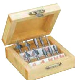
Una fresa per scanalature Ø 3,2 - 4,8 e 6,5 mm, fresa concava Ø 6,4 mm, fresa per scanalature a V Ø 6,5 mm, fresa per scanalature 6,5/2,5 mm, fresa convessa R 3,2 mm, fresa cilindrica 6,4 mm, fresa per arrotondare con guida 5 mm, Fresa con angolo di 45°. Ordinatamente custodite in cassetta di legno. Singole frese a profilo per legno a pagina 35.
