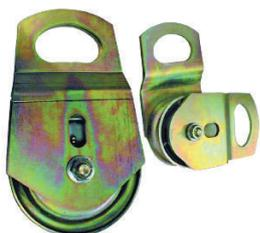
**Carrucole apribili. Ruote in ghisa, telaio in acciaio zincato. Rotazione su bronzine, con ingrassatore. Certificate FEM M4**
