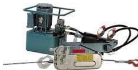
I paranchi tirfor® TU-H sono azionati meccanicamente da un cilindro idraulico utilizzando un pacchetto di alimentazione elettrico o a benzina. La TU-H aggiunge flessibilità all'operatore, in particolare durante l'uso intensivo e il movimento di carichi su lunghe distanze.
